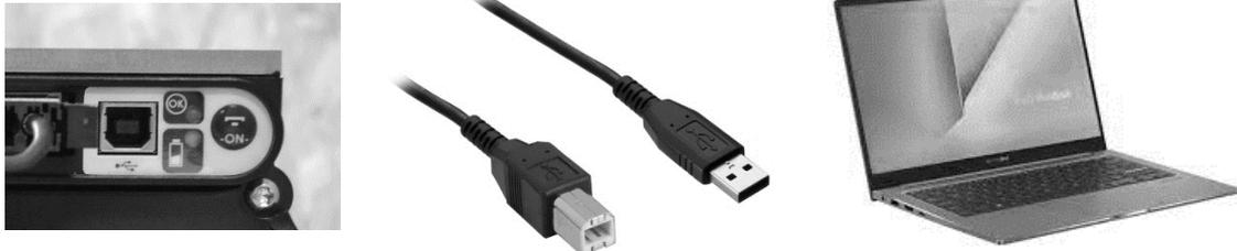
*Figure 1 - Branchement de la prise USB-B au port situé à l'arrière de la roue
