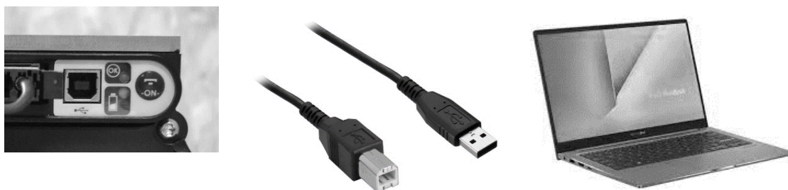
Figure 1 - Schließen Sie die USB-B-Buchse an befindet sich am Heck des Rades Schließen Sie das USB-A-Kabel an das Rad an
